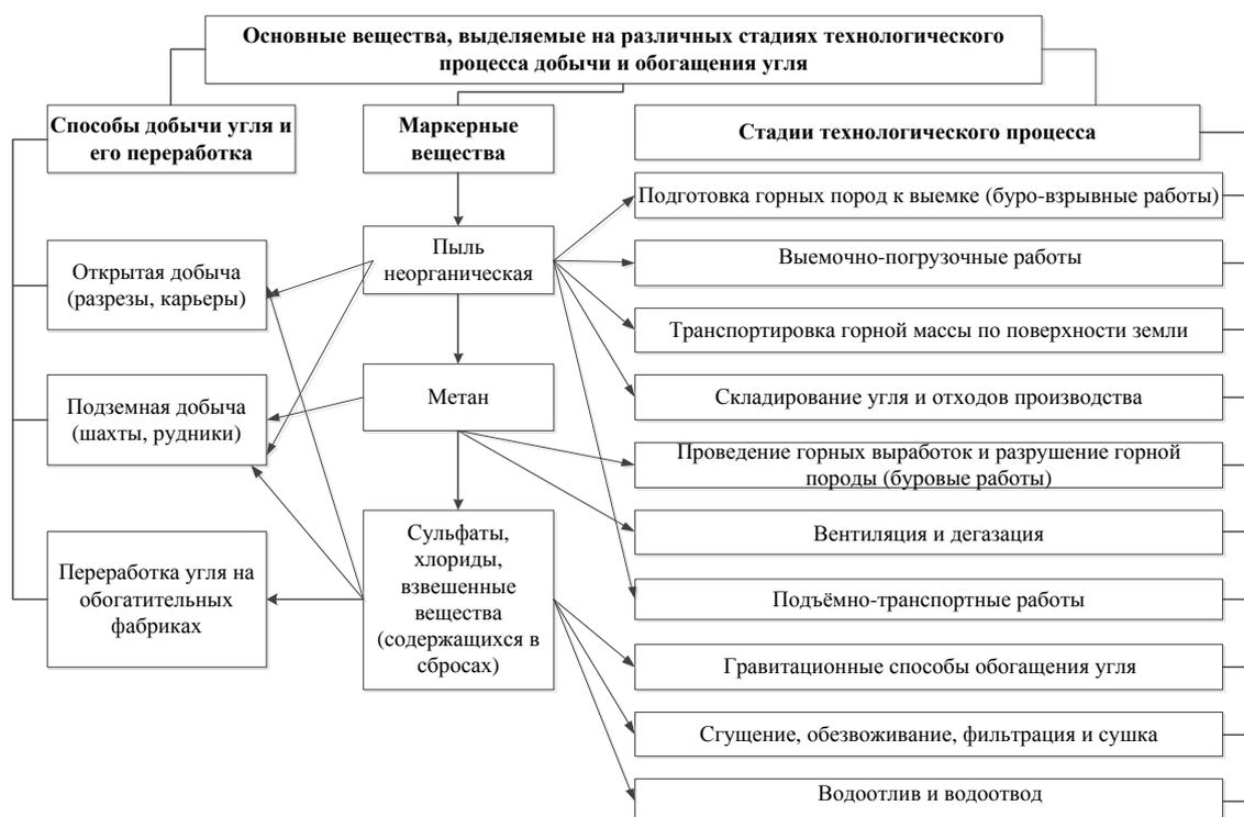
Рисунок 1 – Маркерные вещества технологического процесса добычи и обогащения угля АО «Ургалуголь»
