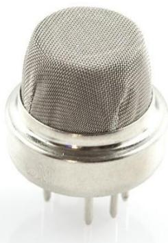
Рис. 1 датчик газа MQ-4
