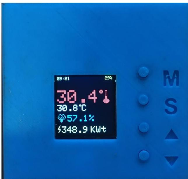
Рисунок 3. Разработанный терморегулятор (реле замкнуто)
