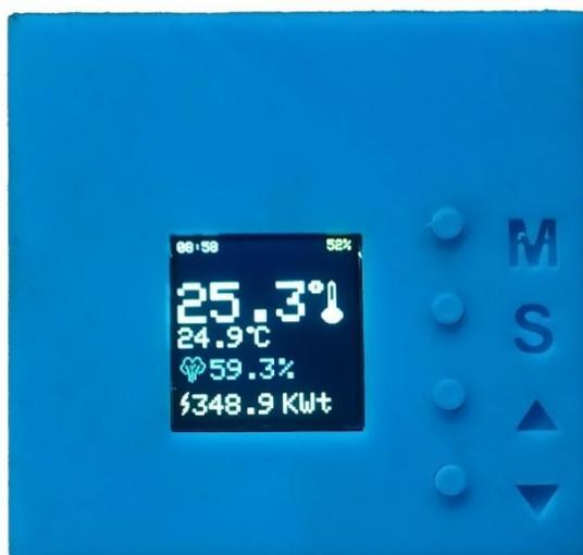
Рисунок 2. Разработанный терморегулятор (главное меню)
