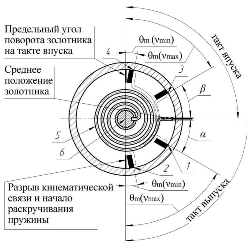
Рисунок 5 - Изменение положений упоров для возвратной пружины при изменении частоты вращения
