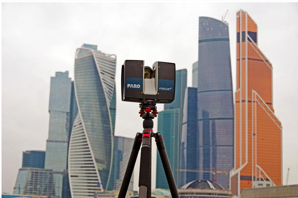
Рисунок 1 – Наземный стационарный лазерный сканер
