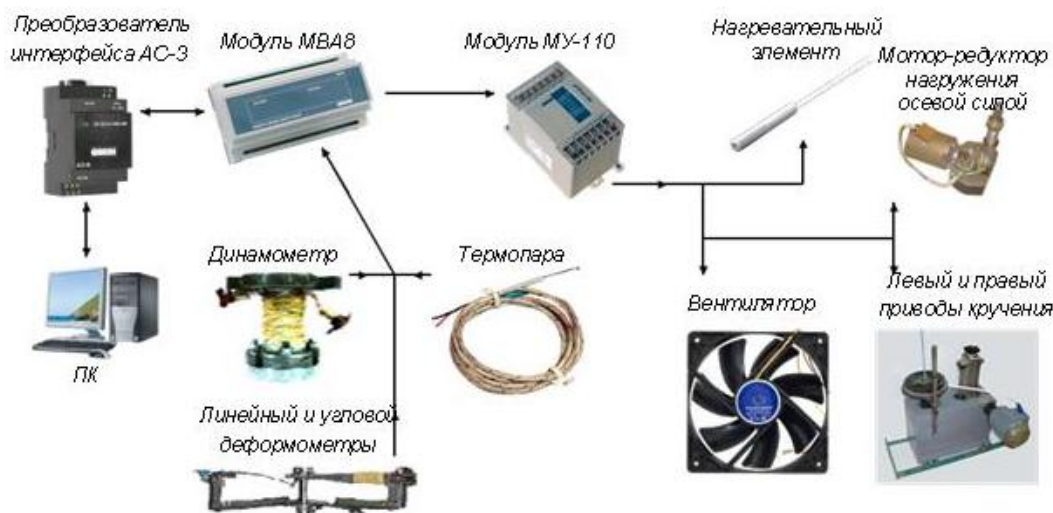
Рисунок 6 – Структурная схема измерительно-регистрающей аппаратуры и аппаратуры управления
