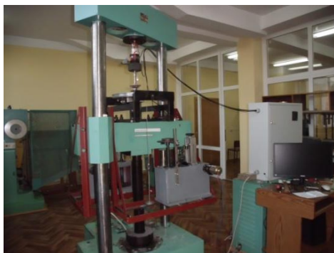
Рисунок 2 – Универсальный автоматизированный комплекс механических испытаний СНК-ЭВМ
