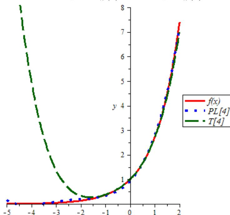
Рисунок 3 – Графики функции  $f(x) = e^x$  и её приближений многочленами Лежандра  $PL_4(x)$  и Тейлора  $T_4(x)$
