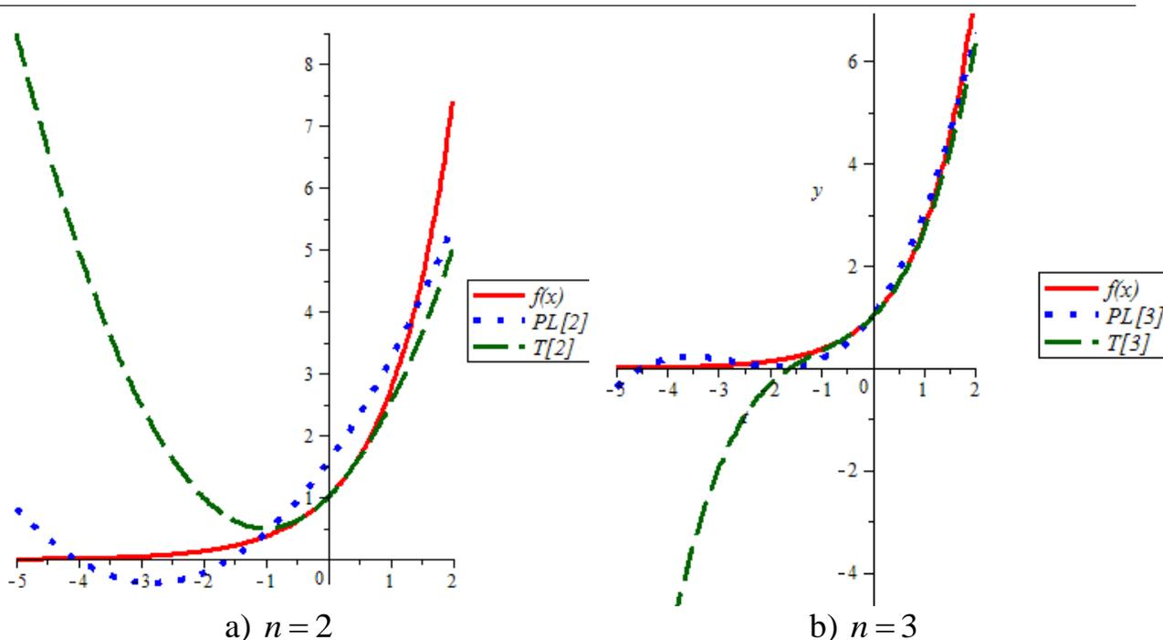
Рисунок 2 – Графики функции  $f(x) = e^x$  и её приближений многочленами Лежандра  $PL_n(x)$  и Тейлора  $T_n(x)$
