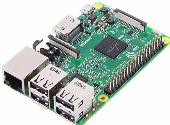
Рисунок 2 – Микрокомпьютер Raspberry PI 3
