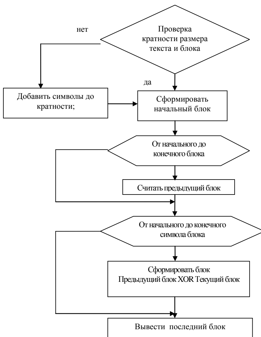
Рисунок 1 - Блок схема формирования цифровой сигнатуры
