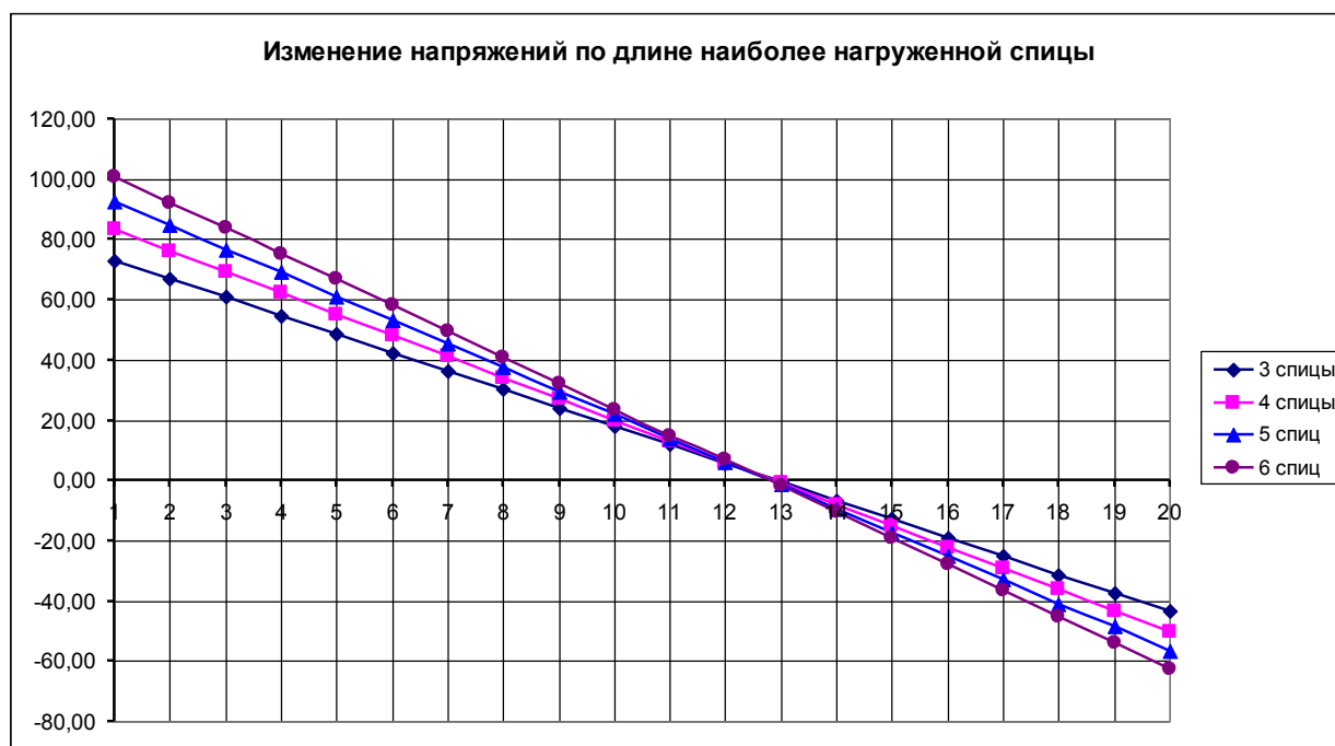
Рисунок 3 - Изменение напряжений по длине спицы автомобильного колеса применительно к трех-, четырех-, пяти- и шести спицевой конструкции
