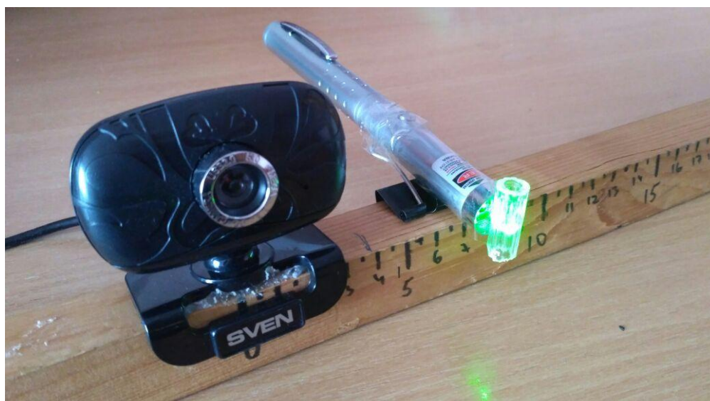
Рисунок 2 – Расположения лазерной указки и камеры относительно друг друга
