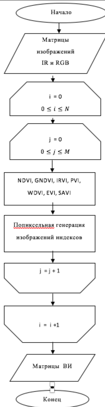
Рисунок 2 – Блок-схема обработки изображений для расчёта вегетационных индексов
