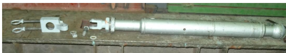
Рисунок 5 – Конструкция стойки в составе упорной тяги после испытаний
