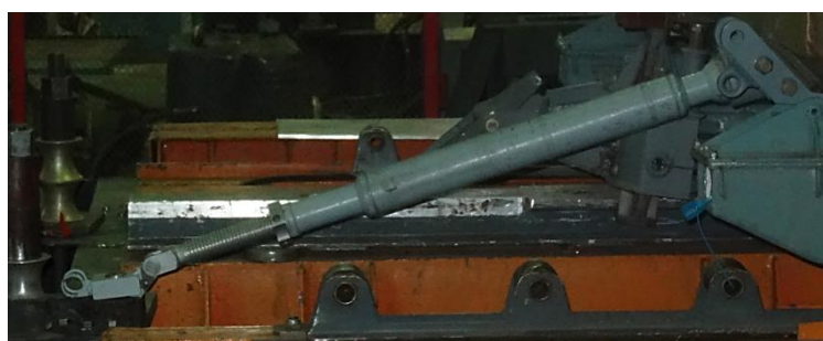
Рисунок 14 – Испытания упорной тяги на случай расположения габаритно-массового транспортного средства в конце грузовой кабины
