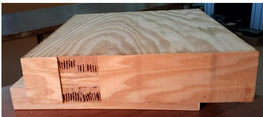
Рисунок 7 – Многопустотная фанера с трехслойной внутренней частью
