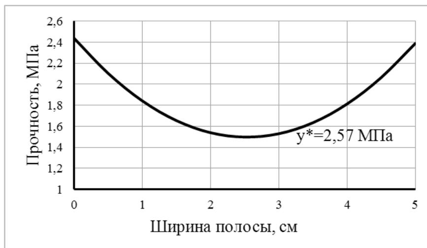
Рисунок 4 – Влияние ширины полосы шпона в плетне на прочность при скалывании вдоль волокон
