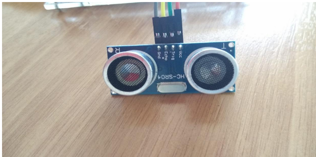
РИС. 1 - Ультразвуковой датчик HC – SR04
