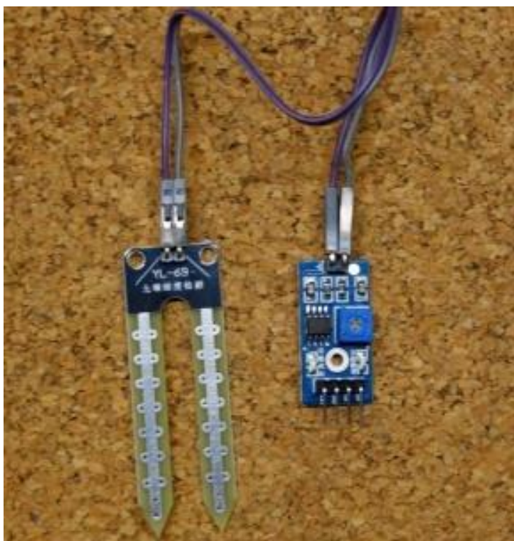
Рис. 1 Датчик уровня влажности YL-69
