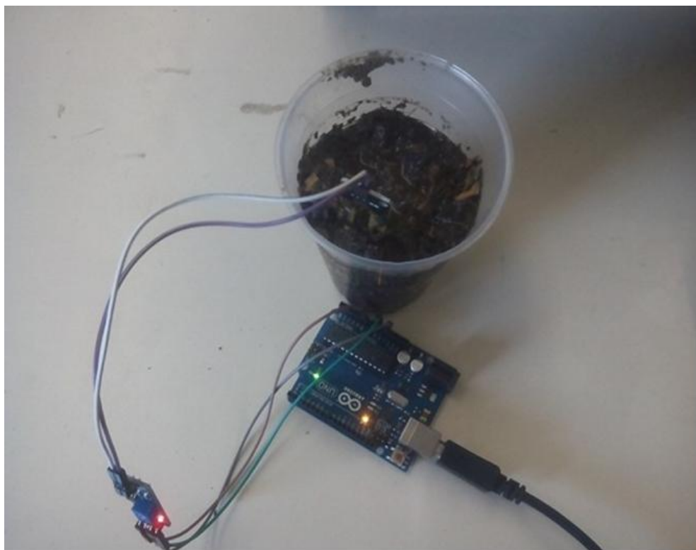
Рис. 3 Собранный вариант Arduino и датчика влажности
