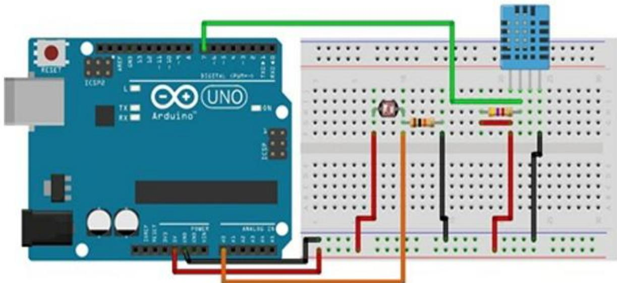
Рис. 2 Схема подключения датчика температуры и освещенности
