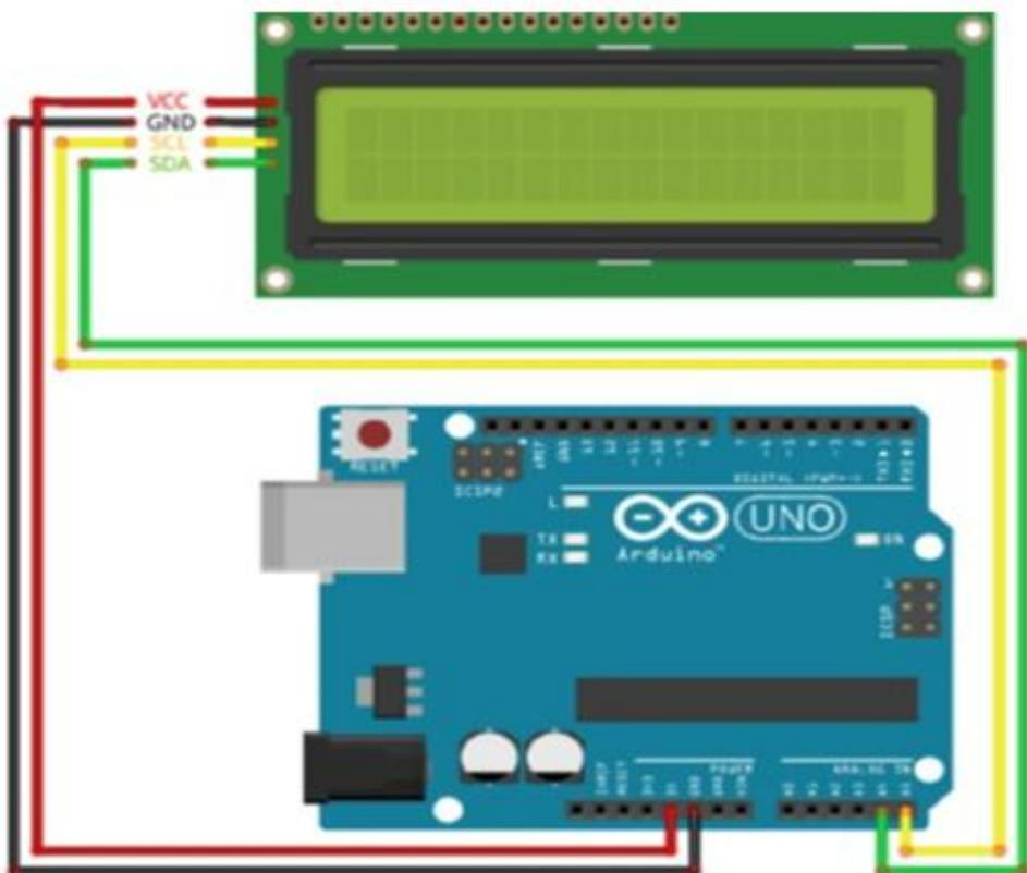
Рис. 4 Схема подключения ЖК-экрана к Arduino
