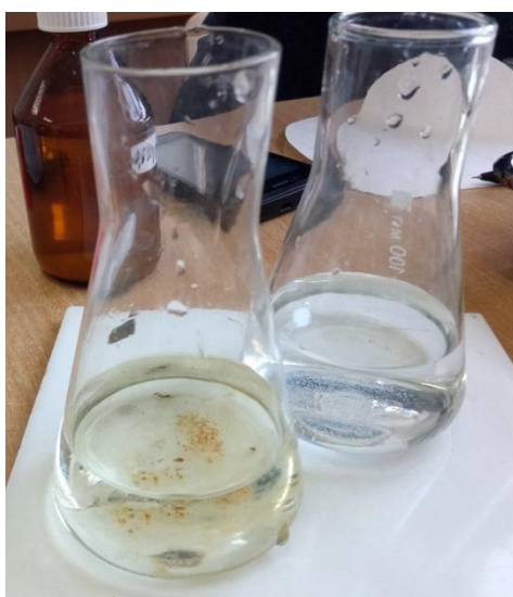
Рисунок 3 – Слева – оттитрованная проба раствором тиосульфата Na, справа – нетитрованная проба
