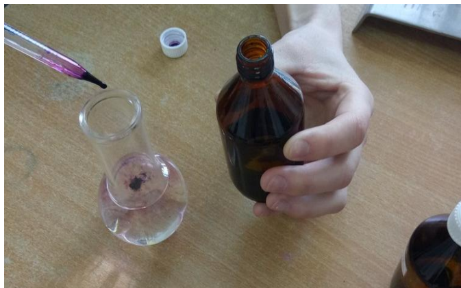
Рисунок 3 – Добавление темно-синего хрома в исследуемую воду
