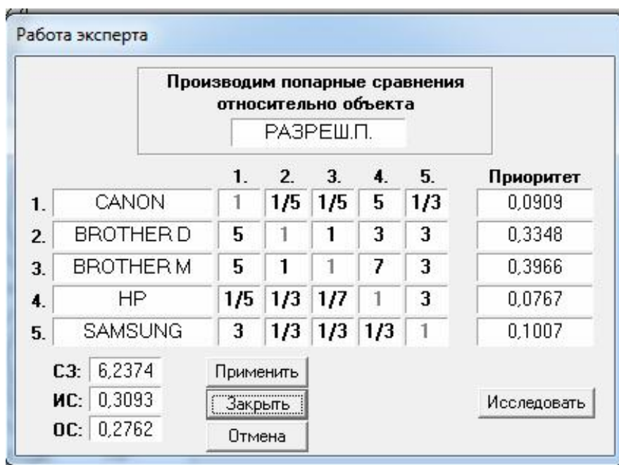
Рисунок 2 - Сравнение выбранных МФУ относительно критерия «Разрешение печати»
