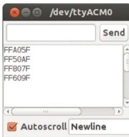
Рис. 2. Расшифровка сигналов с ИК приемника
