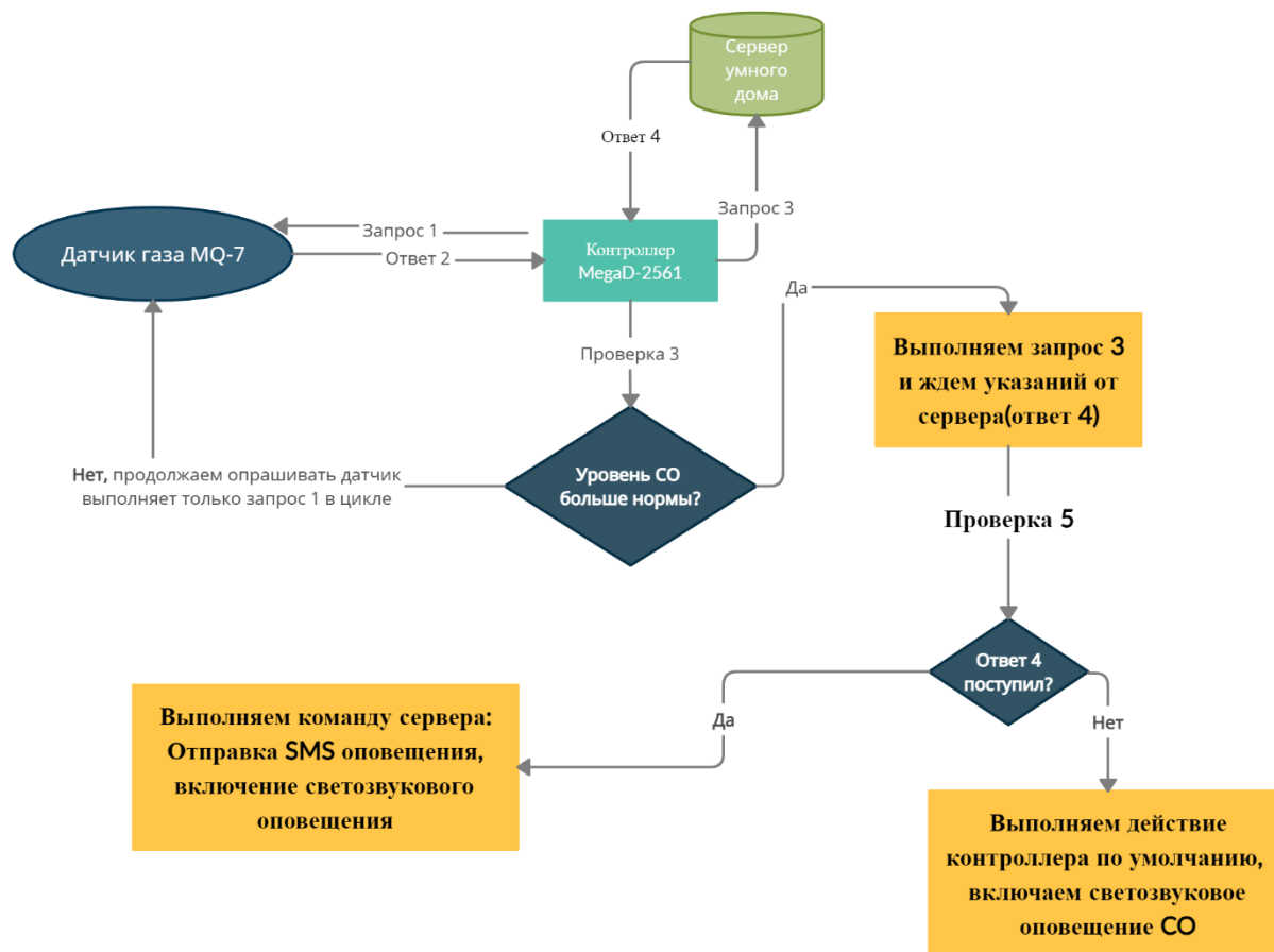
Рисунок 1.6 – Самостоятельная работа контроллера MegaD-2561 по определению концентрации угарного газа(CO)
