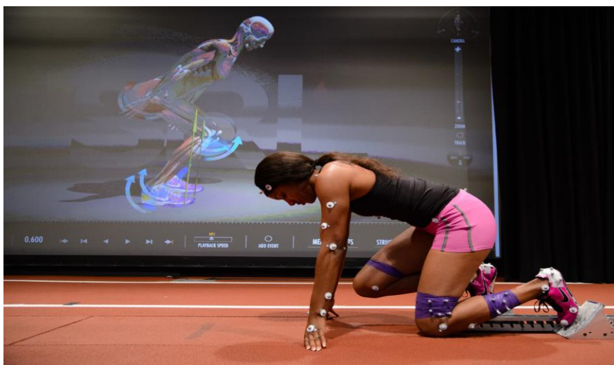
Рис.3. Использование датчиков для анализа нагрузки на разные части тела.
