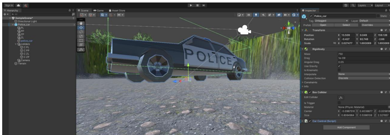
Рисунок 5 – Добавление компонентов «Rigidbody» и «BoxCollider» авто
