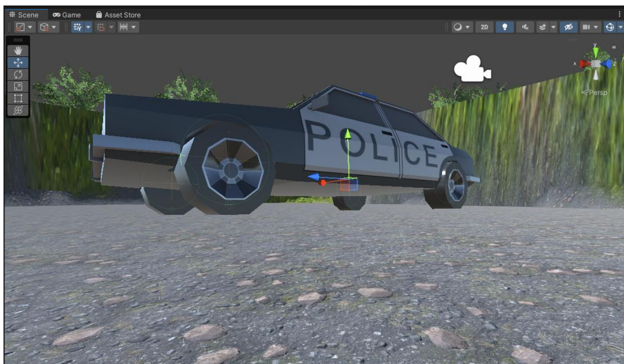
Рисунок 4 – Конечное расположение коллайдеров колес
