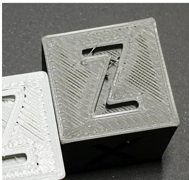
Рисунок 4 – Недоэкструзия (расстояние между линиями)
