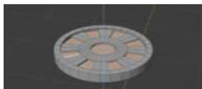
Рис.52 Экструдирование середины вниз
