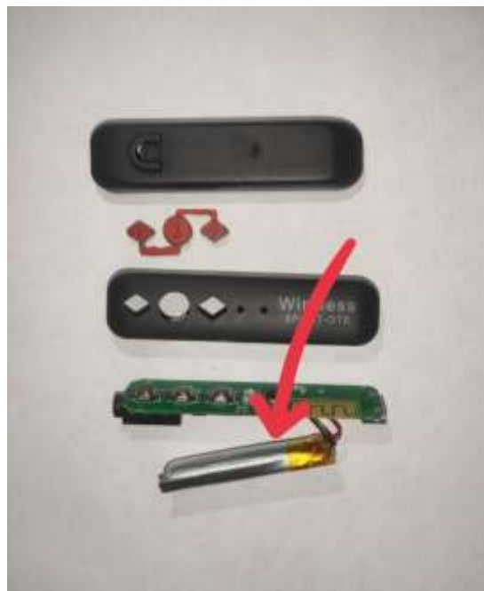
Рисунок 3 – Внешний дефект аккумулятора
