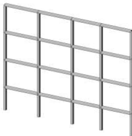
Рисунок 6 – Пространственная модель рамы
