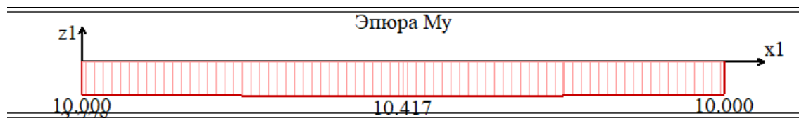
Рисунок 10 – Участок плиты, где присутствует максимальный изгибающий момент
