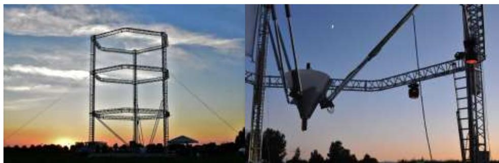
Рисунок 4 – Трехопорный принтер Big Delta
