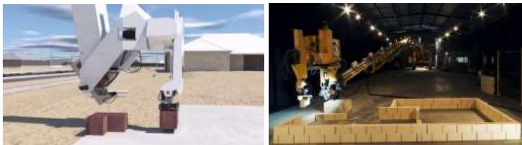
Рисунок 1 – Строительный робот Hardian X
