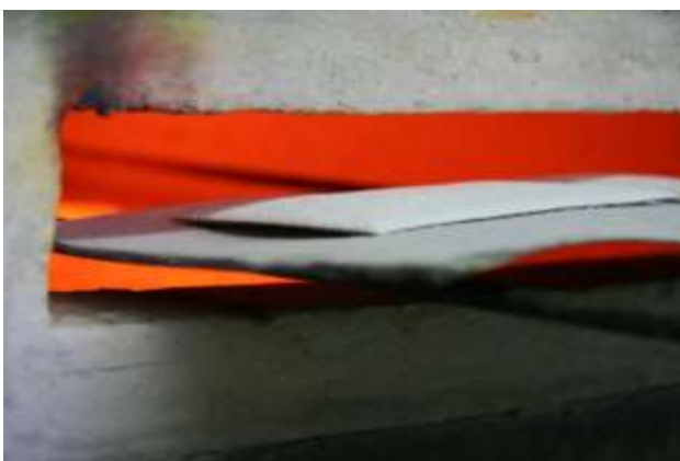
Рисунок 7 – Процесс изготовления финифти. Этап обжига
