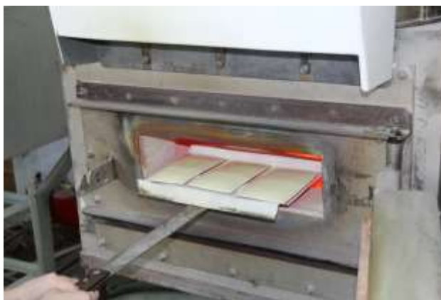
Рисунок 6 – Процесс изготовления финифти. Этап обжига
