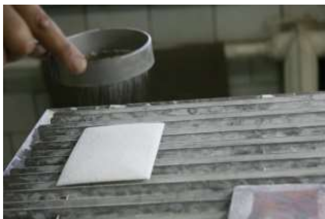
Рисунок 4 – Процесс изготовления финифти
