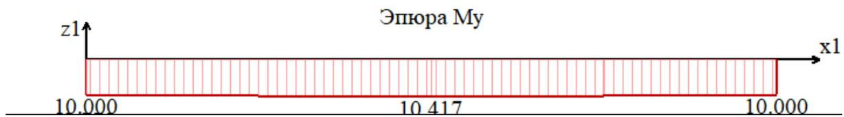
Рисунок 9 – Участок плиты, где присутствует максимальный изгибающий момент
