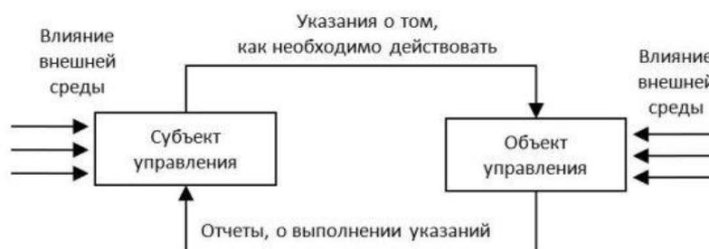
Рисунок 1 – Система управления по Винеру
