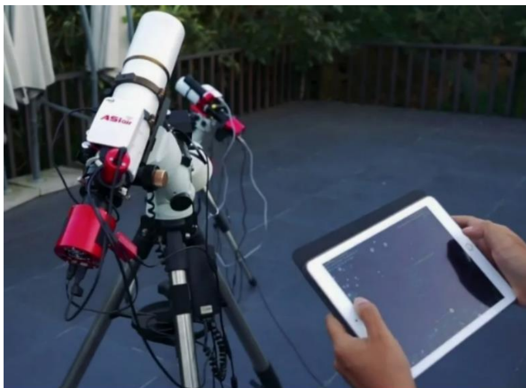
Рисунок 1. Подключение миникомпьютера ASIAIR к гаджету и телескопу
