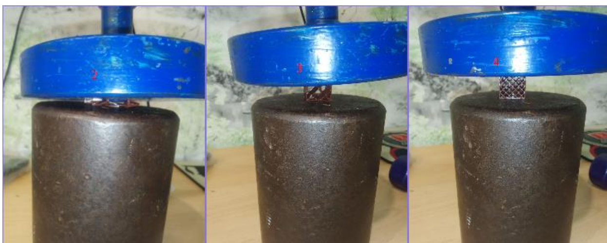
Рис 10. Оценка прочности образцов весом 20кг
