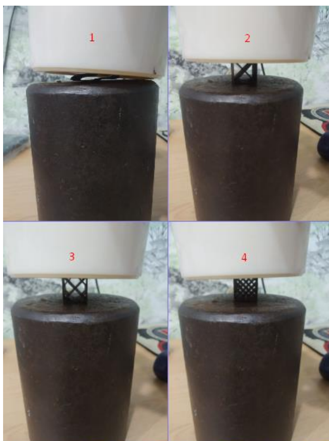
Рис 8. Оценка прочности образцов весом 10кг
