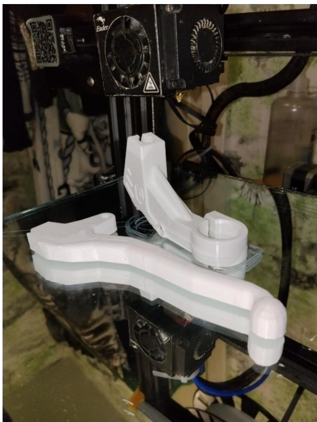
Рисунок 4. Напечатанный на 3д-принтере рычаг сцепления из PLA
