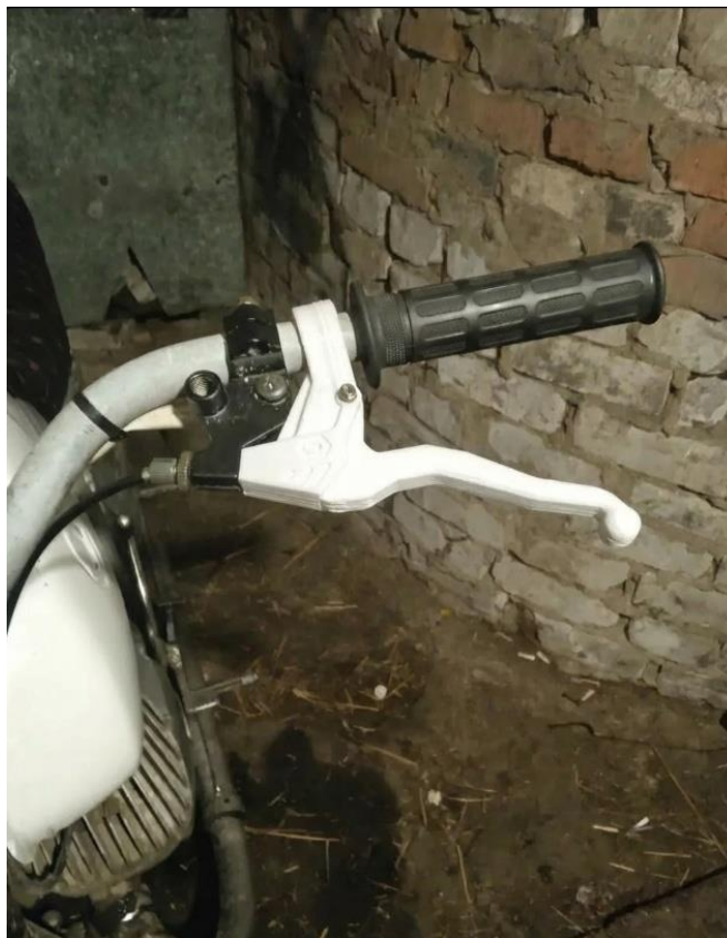
Рисунок 5. Установленный напечатанный рычаг сцепления на руле мопеда
