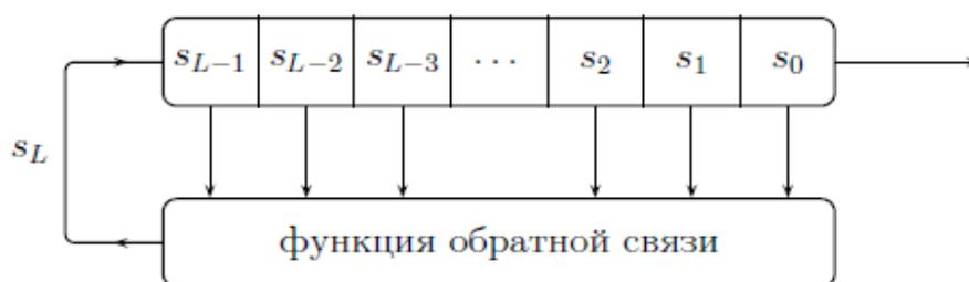
Рисунок 1 – Схема работы LFSR
